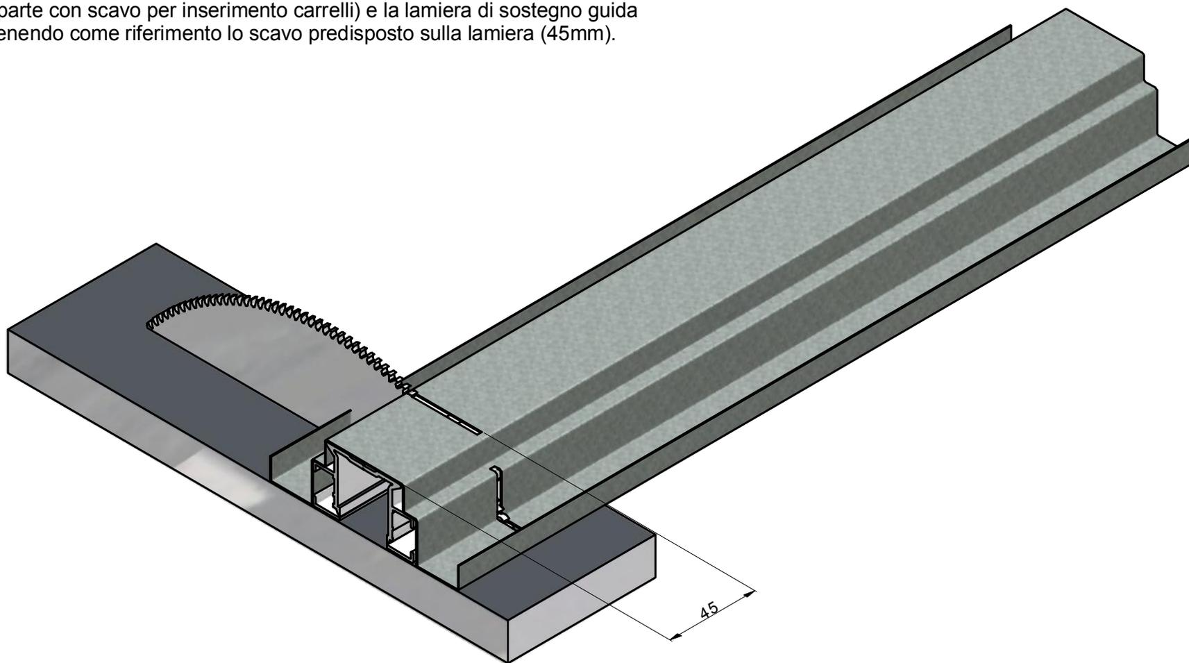
Si consiglia di fissare con ulteriori viti la parte anteriore della guida con la lamiera di sostegno, per garantire una maggiore solidità della struttura. Dettaglio C.
