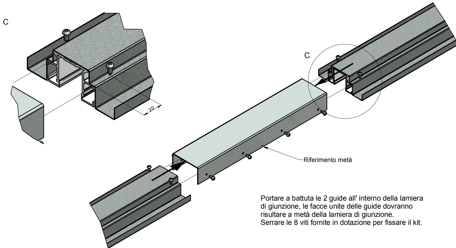
Portare a battuta le 2 guide all' interno della lamiera di giunzione, le facce unite delle guide dovranno risultare a metà della lamiera di giunzione.
